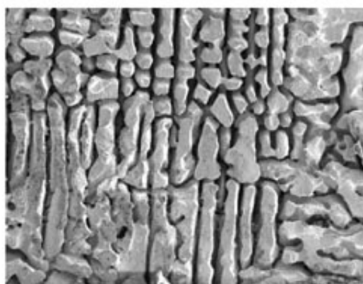
10 мкм Рис. 16. Корродированный образец Pb-Sb-Cd-(Se)-(Ag) сплава.
