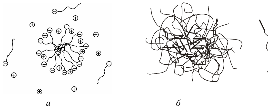
Рис. 2.3. Схематическое изображение мицеллы анионного (а) и неионного (б) ПАВ
