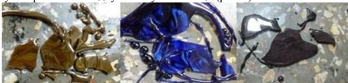
Рис. 1. Отримані кольорові стекла для виготовлення емалей
